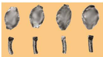
Рисунок 4. Современная реконструкция монетных заготовок из проволоки до и после плющения, используемых для получения русских монет типа псковской денги из серебра (около 1510 года) и тверского пула из меди (примерно того же времени).
